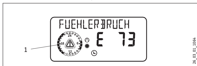
1 Chybové hlášení (blikající)
